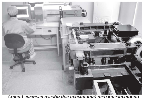
Стенд чистого изгиба для испытаний тензорезисторов
