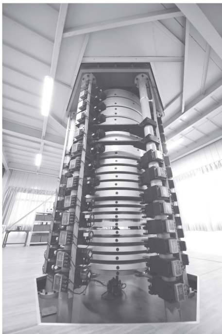
Установка прямого нагружения для калибровки датчиков до 50т
