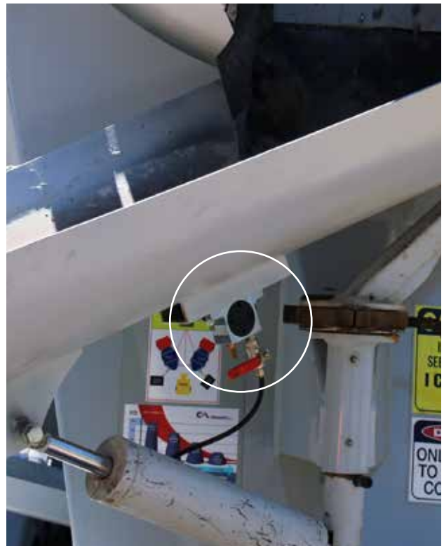
OT (роторный пневматический вибратор) - Желоб для бетономесителя.
